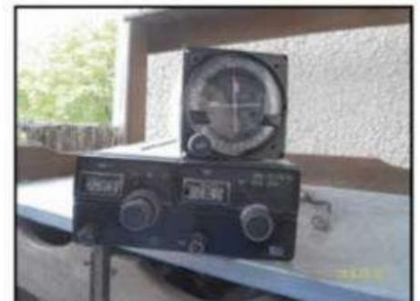
**Funkgerät KX175B, GPI KI-214**, Wegen Umbau übrig. King Kx175B mit Gleitpathindikator passend, für ILS-Anflüge, abnahme- und funktionsfähig, inkl. Kabelsatz, von privat, VB 500,- €. Tel. 0160/4241349
