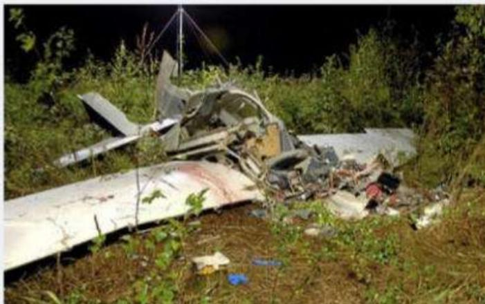
Einweisung mit tragischem Ende: Möglicherweise führte eine Böe zum einseitigen Strömungsabriss. Obwohl beide Piloten routiniert waren, konnten sie das Trudeln nicht rechtzeitig beenden.
