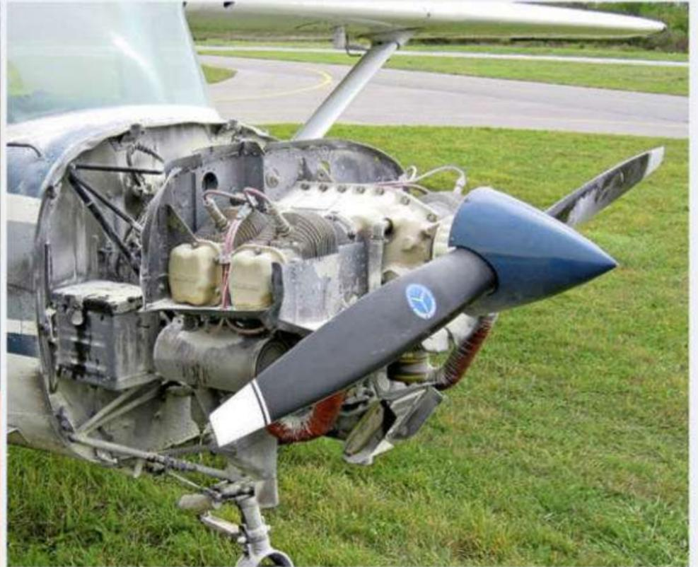
Brenzlige Angelegenheit: Bei Verdacht auf Vergaserbrand muss der Anlasser weiter betätigt werden, damit die im Ansaugbereich züngelnden Flammen in die Zylinder gezogen werden. Nach so einem Vorfall ist eine sorgfältige Inspektion in einer Werkstatt vonnöten.
